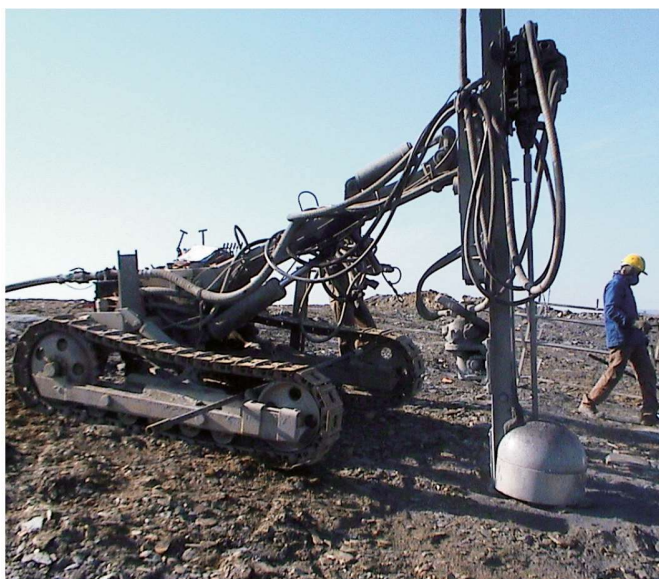
Figura 1 - Amostrador setorial com cúpula para captação de finos.
