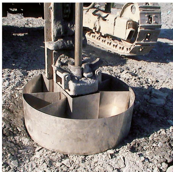
Figura 2 - Amostrador setorial acoplado à lança da perfuratriz.
