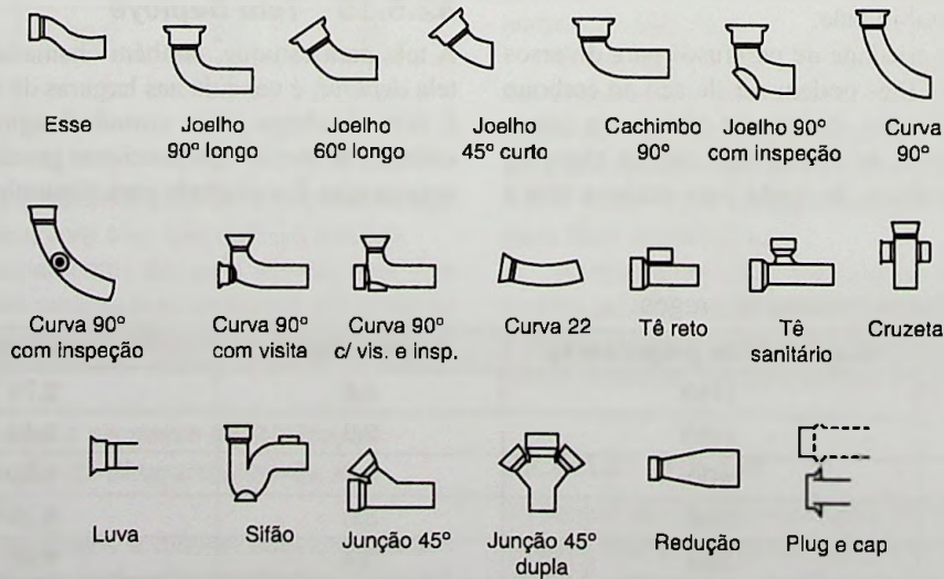
FIGURA 32.30 Tipos de conexão ponta e bolsa.
