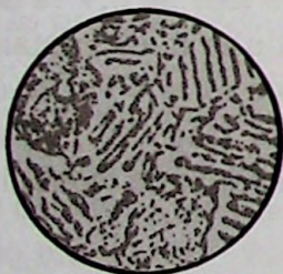
FIGURA 32.16 Nos ferros fundidos, o excesso de carbono se precipita na forma de cristais de grafita, misturados à ledeburita e à perlita.
