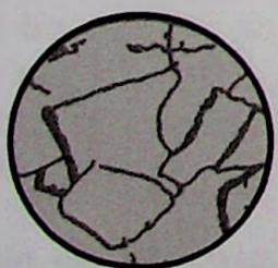
FIGURA 32.17 Aspecto granular da austenita, que, nos aços hipoeutetoides, começa a se formar acima de 723 °C.
