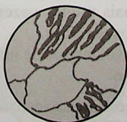
FIGURA 32.13 Aspecto escuro da cementita ( \text{Fe}_3\text{C} ).
