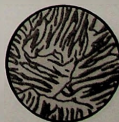
FIGURA 32.14 Ao conjunto branco (ferro \alpha ) e preto ( \text{Fe}_3\text{C} ) de aspecto zebreado dá-se o nome de perlita.
