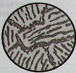
FIGURA 32.15 Na ledeburita, o interior dos grãos é totalmente perlítico e, nos contornos de grãos, é depositado o excesso de carbono na forma de \text{Fe}_3\text{C} .
