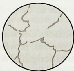
FIGURA 32.12 A microestrutura cristalina do ferro ao se observar no microscópio é granular.
