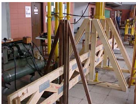
Figura 7- Esquema do ensaio de flexão estática do elemento estrutural.
