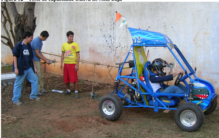
Figura 12 – Teste de capacidade trativa do Mini Baja
