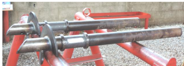
Figura 2. Seções guia das estacas helicoidais EH1 e EH2 em preparação para instrumentação.
