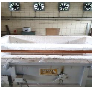
Figura 7 – Viga mista de madeira e concreto no forno horizontal
