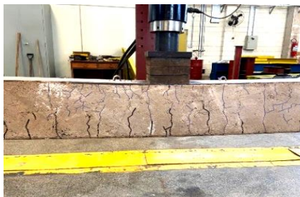
Figura 4 – Ensaio de viga mista de aço e concreto em temperatura ambiente após incêndio
