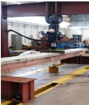
Figura 7 – Viga mista de madeira e concreto no forno horizontal
