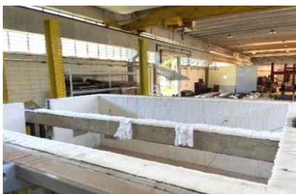
Figura 4 – Ensaio de viga mista de aço e concreto em temperatura ambiente após incêndio
