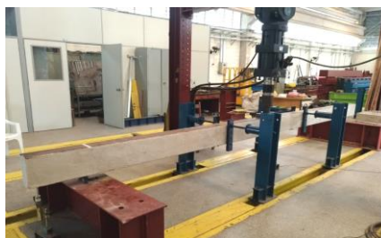
Figura 3 – Viga mista de aço e concreto no forno horizontal
